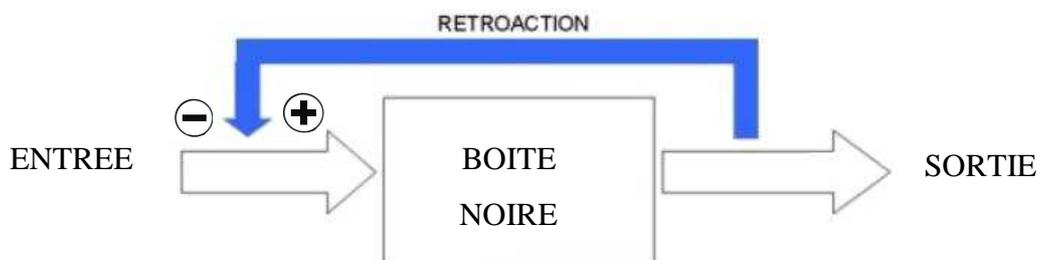
Les éléments d'un système sont en interactions réciproques, c'est à dire que l'action d'un élément sur un autre, entraîne en retour une réponse (rétroaction) constituant une boucle de rétroaction. Ces feed-back peuvent être positifs (amplification) ou négatifs (atténuation). L'équilibre d'un système requiert donc un nombre suffisant de boucles négatives, où un élément A fait augmenter B, mais où en retour l'augmentation de B fait diminuer A.
