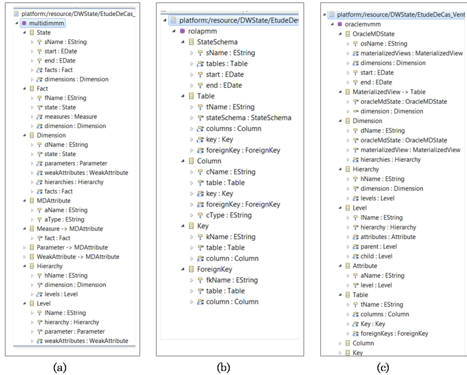
FIGURE 5.4 – Métamodèles de notre approche implantés en Ecore
